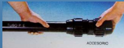
Tubo de P.E. introducido en el accesorio
